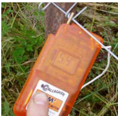
Bild 4. Med en voltmätare kontrollerar man spänningen på stängslet.
